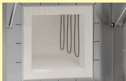
Ofenraum mit hochwertigem Fasermaterial und Heizelementen aus Molybdän-Disilizid in beiden Seiten
