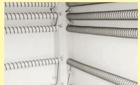
Ausführung als LF-Modell für kürzere Aufheiz- und Abkühlzeiten
