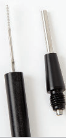
図3:キャップを完全に取り外し、プローブ先端のブラシが見えて掃除できる状態
